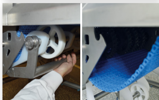
Openklapbare aandrijfunit voor eenvoudige reiniging
